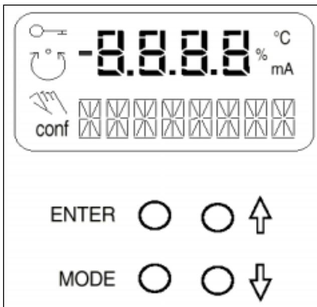
Rys. 6. Elementy wskazań na aparacie TZID-C
